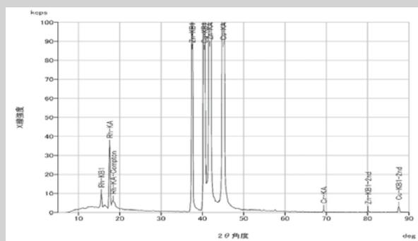
元素固有の二次X線スペクトルを得ること未知試料の元素定性分析が可能。ピーク高さ等から定量性も得られる(FP法)。測定のメリットは、非破壊分析であること・前処理が単純なため、比較的迅速に測定が可能であること等が挙げられる。ただし、定量性についてはICP発光などの測定ほどの精度は出ず、おおよその値を知りたい場合に有用。
