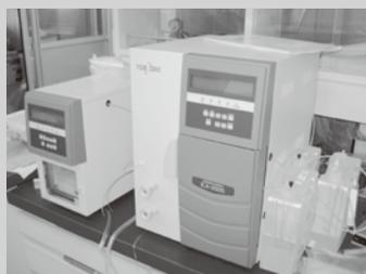
現在所有しているカラムでは、水溶液中に含まれる陽イオン(Li<sup>+</sup>, NH<sub>4</sub><sup>+</sup>, Na<sup>+</sup>, K<sup>+</sup>, Ca<sup>2+</sup>, Mg<sup>2+</sup>)と、陰イオン(F<sup>-</sup>, Cl<sup>-</sup>, NO<sub>2</sub><sup>-</sup>, Br<sup>-</sup>, NO<sub>3</sub><sup>-</sup>, PO<sub>4</sub><sup>3-</sup>, SO<sub>4</sub><sup>2-</sup>)の定性・定量分析が可能。イオン種限定であるため多様性はないが、その分簡便・迅速に測定ができる。
