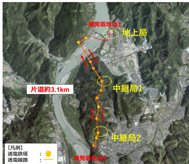
通信装置設置位置
