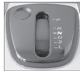
ハーフミラー外観の応用例 (上図:バックライト点灯前、下図:点灯後)
