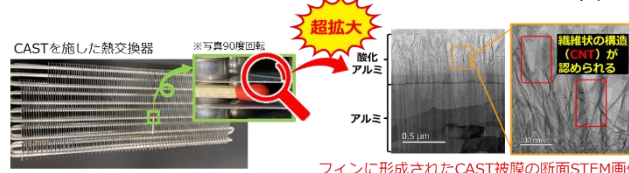
フィンに形成されたCAST被膜の断面STEM画像
